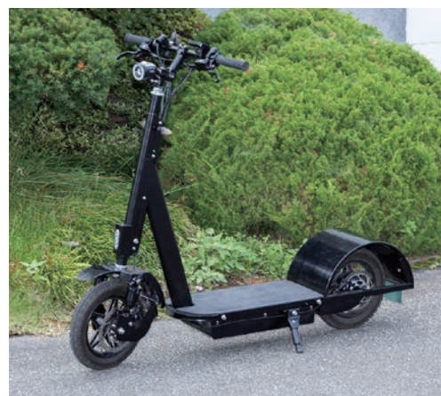
特許を取得した同社オリジナルの電動キックボード。後輪トラックを写真の「1輪」から「2輪」に交換が可能。前後ディスクブレーキ装備などさすがの仕上がり。
