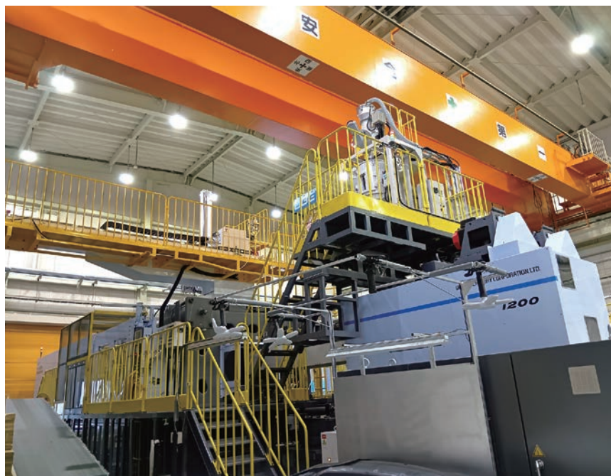
自動車部品部門における、生産能力・生産効率・品質の向上や、部品の大型化需要等、受注競争力の向上を図る目的で今期導入した、3,500トンの大型樹脂成形機
