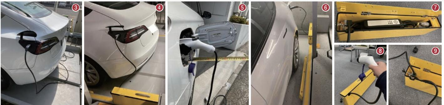
③ このように充電ケーブルの余剰分がパレット上に放置された状態でパレットが動作すると、ケーブルを巻き込むなど事故のリスクがある。④ 一方、こちらは充電対応の開発品が取り付けられたパレット。車両充電口の近くに設置されたコンセントボックス(写真下側の黄色の箱)に、充電ケーブルの余剰分が収納され、安全な状態(写真③との違いに注目)。⑤ 充電口のフタの飛び出し量を計測。⑥ 車両充電口のフタや充電ガンがパレットからはみ出さないよう、駐車位置を規制するガイドやライン外への飛び出しを注意喚起するラインを設置。⑦ 充電ケーブルを収納した状態のコンセントボックス。⑧ 充電ケーブルを引き出した状態。⑨ 充電ケーブルの長さをどの程度規制するかを検証中。
