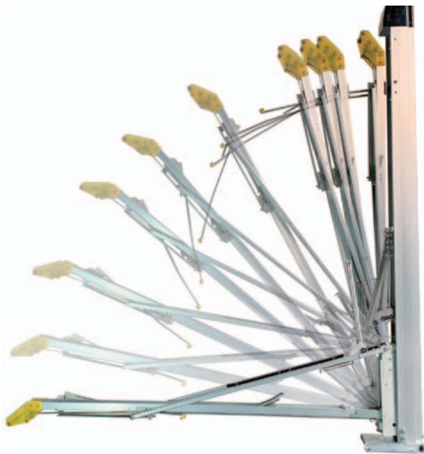
AFS型の上段ラックは自転車を出庫した後、自動的に折り畳まれて支柱に収まる。ガススプリングの採用で折り畳まれる動きは非常にソフトだ
