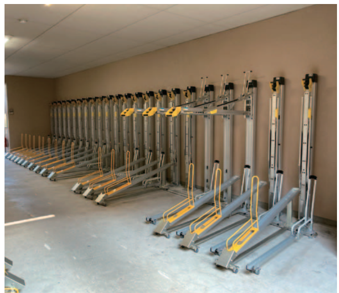
AFS型の上段ラックは自転車を出庫した後、自動的に折り畳まれて支柱に収まる。ガススプリングの採用で折り畳まれる動きは非常にソフトだ
