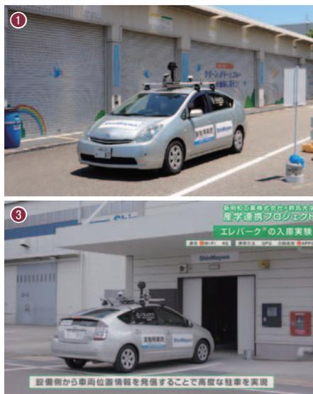
①新明和工業では宝塚工場敷地内でエレベータ方式と二・多段方式の機械式駐車設備への自動運転車の自動入庫、および複数の通信と誘導方法の組み合わせによる、この2つの設備間の自動走行を実現する車路管制システムの実証実験を行った ②二・多段方式駐車設備への自動運転による後退駐車 ③エレベータ式駐車設備への自動駐車
