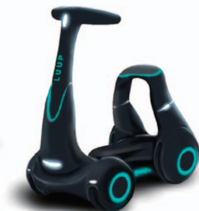
Luupが近未来に投入しようとしている電動マイクロモビリティ。左は若者が利用する状態で、椅子が畳まれ最高時速20kmに。右は高齢者が利用する状態で、椅子が現れ、最高時速6kmに制限される(提供/Luup)
