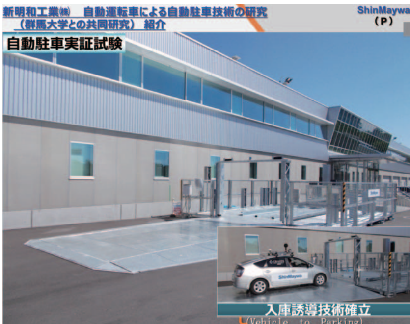
工業会の有力会員企業である、新明和工業株式会社と群馬大学による共同実験。機械式駐車設備へ自動運転車の誘導を試みた。自動運転車と機械式駐車設備の協調により、安全かつ高精度な自動入庫の実現に期待ができる(画像提供/ IHI運搬機械)
