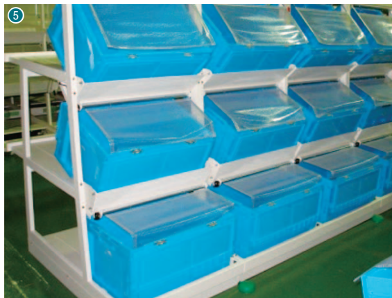
⑤⑥はいずれも物流倉庫向け仕分け装置。商品をバーコードのスキャンなどでシステムに認識させると、仕分け先の間口に設置されている開閉式ゲートが自動的に開く。1回の投入で1つの間口しか開かないので誤って商品を投入する恐れが非常に低い ⑦以前から主力の製品となっている食品工場向けコンベア
