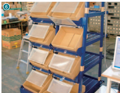
⑤⑥はいずれも物流倉庫向け仕分け装置。商品をバーコードのスキャンなどでシステムに認識させると、仕分け先の間口に設置されている開閉式ゲートが自動的に開く。1回の投入で1つの間口しか開かないので誤って商品を投入する恐れが非常に低い ⑦以前から主力の製品となっている食品工場向けコンベア
