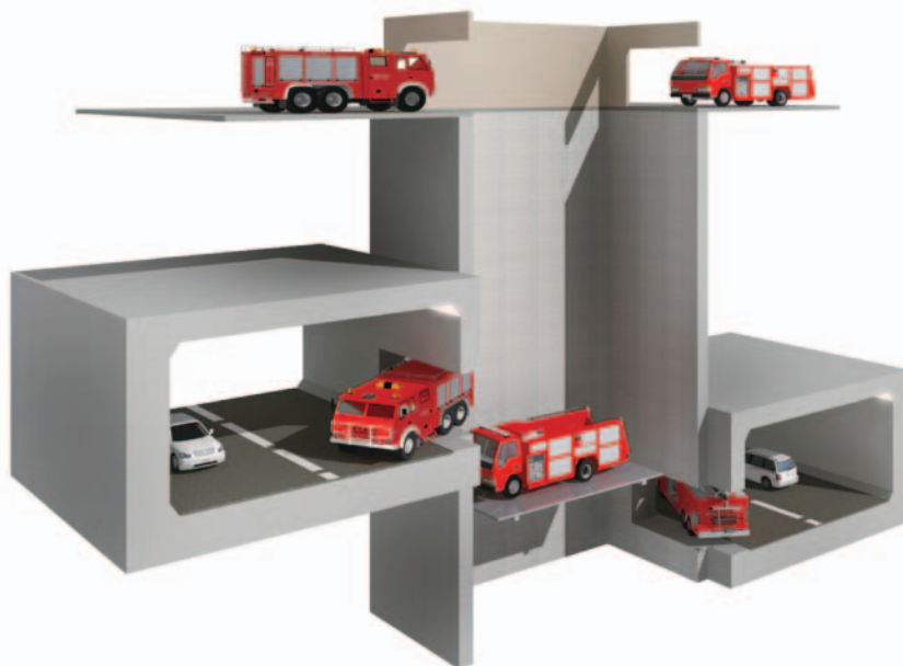
高速道路の地下トンネルへ設置し、有事の際に使用される特殊緊急車両(消防車)用エレベーター。積載量 10.5t
