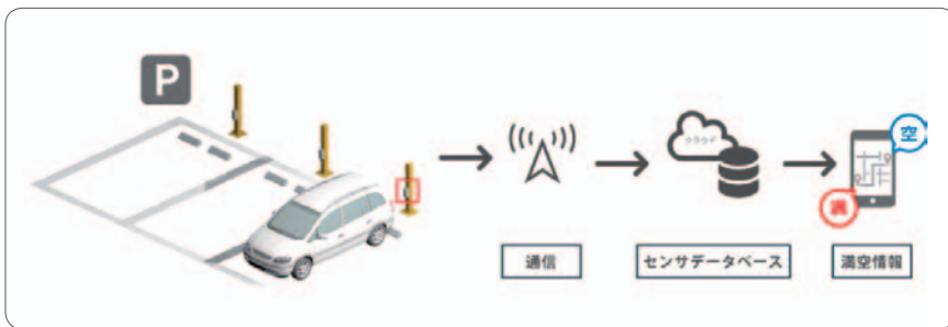
IoTセンサ&データ提供ソリューション「オプテックスセンサコネク」の仕組み。駐車場に設置した車両検知センサにより、遠隔地で満空状況を管理・確認できる。地中にループコイルセンサを埋設せず、最小限の投資で駐車管理ができる
