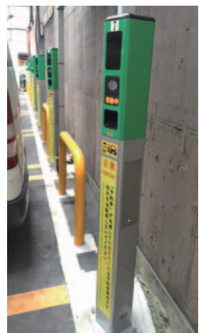
去る2月、東京・浜松町で稼働した予約制のコインパーキング。各車室には車両ナンバー認識システムが設置され、ロック板はない
