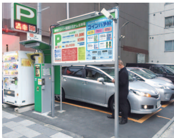
去る2月、東京・浜松町で稼働した予約制のコインパーキング。各車室には車両ナンバー認識システムが設置され、ロック板はない
