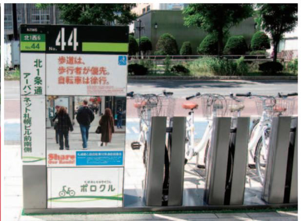
札幌市北1条通(国道)自転車走行空間環境改善社会実験として、車道側から直接乗り入れ可能なポートを設置した。自転車利用者へのメッセージボードも併設し、マナー喚起も行っている(NPO法人ポロクル提供)
