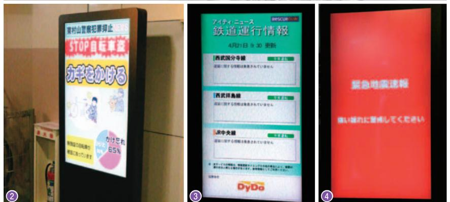
① デジタルサイネージが設置されている東村山駅西口地下駐輪場 ② 駅に直結する通路に設置されたデジタルサイネージ ③④ 平時は鉄道運行情報や時事ニュースを表示し、緊急時には地震速報などの緊急情報を、赤白の明滅表示で強く注意喚起する
