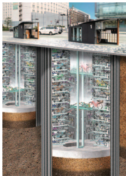
京都駅八条口 西・東自転車駐車場としてエコサイクル3基が導入された。2015年1月完成。新幹線軌道に近く、交通量の多い道路下という制約条件の多い案件だったが、周囲への影響を最小限に抑えて施工。現在、京都市庁舎前にも、2基を整備中
