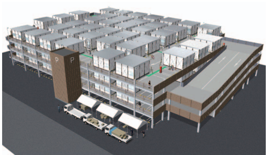
災害時に仮設住宅に転用することを想定し、水道などライフラインのバイピングを行っている日成ビルド工業オリジナルの自走式立体駐車場使用予想パース
