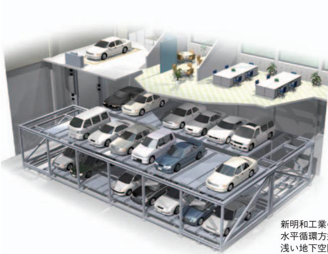
新明和工業の代表的な駐車設備のひとつ、水平循環方式の「クロスパーク」。浅い地下空間でも多層化して活用できる
