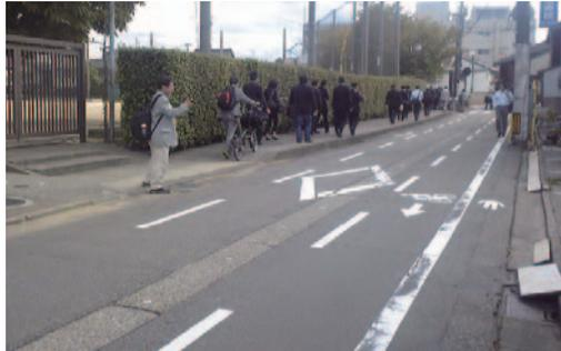
金沢市の“自転車走行指導帯”。明確なピクトマーク、レーン表示で歩車共存を強力に推進している
