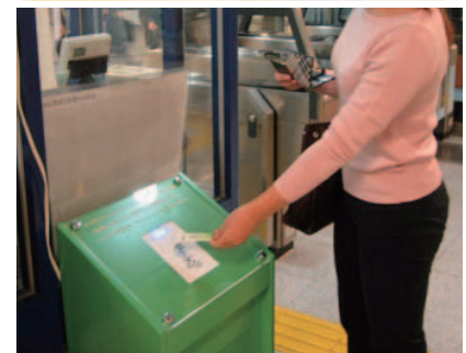
「交通ポイント」で使われた短冊状のICカードと駅に設置されたICカードリーダー
