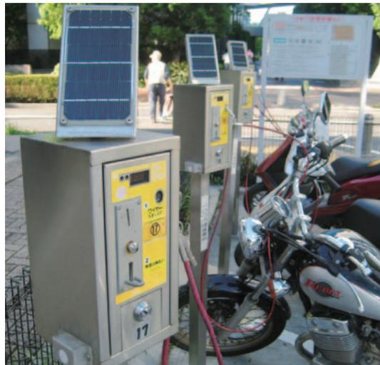
サンラッキーは小規模駐輪場専用のワンコイン式ラック・ラッキーシリーズのひとつ。太陽電池を備えていて、必要な電力はすべて太陽からまかなえるため電源工場の必要がない（蓄電池も内蔵しており雨、曇の日も対応。オプションで100V電源の付設も可能）
