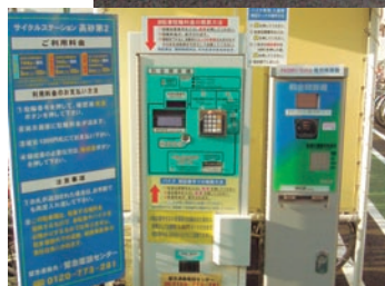
日本信号が開発した新型の料金精算機。左は自転車・バイク駐車場用の精算機。右は非接触ICカード専用精算機
