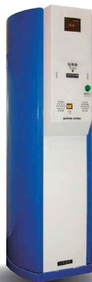
焼津市で稼働中の駐車場精算機「TIM500」。 カード処理部の高速化で混雑時にもスムーズな入場が可能に。連続入場時間は従来7秒だったところが4秒に短縮された
